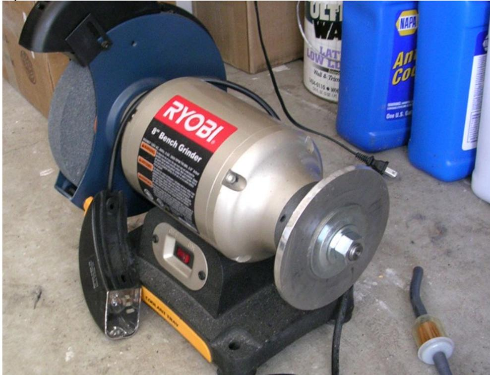
J'ai utilisé une vieille lime sur laquelle j'avais pulvérisé du WD40, et avec les rotations de la meuleuse, j'ai travaillé la plaque jusqu'à ce qu'elle soit uniforme et au bon diamètre. J'ai ensuite fait un léger biseau sur la face extérieure, parce que ma plaque est plus épaisse que celle d'origine.
